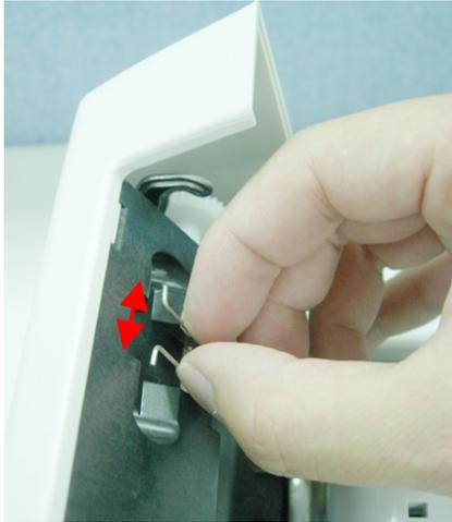
3. Extraiga el rodillo del ADF del escáner.
