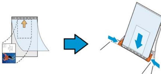
2. Cargue la hoja portadora con la sección gris (sección impresa) hacia abajo.
