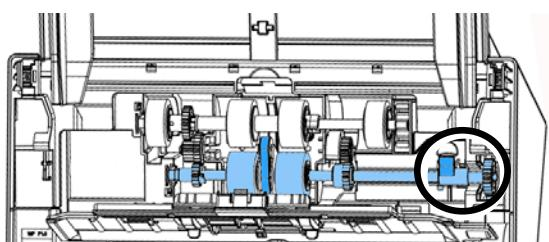
3. Cierre la carcasa del rodillo ADF. Se oirá un sonido de cierre cuando sea instalado correctamente.
