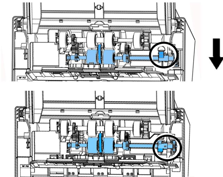
4. Separe el extremo derecho del rodillo ADF de la ranura y extraiga el rodillo ADF superior.
